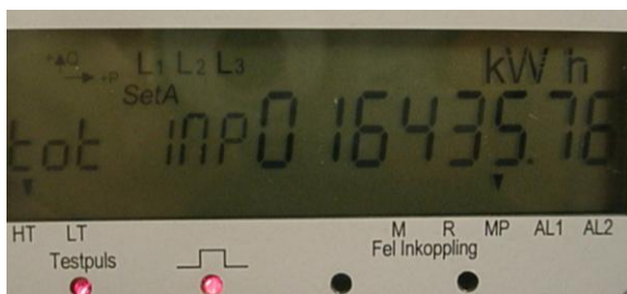
Visar mätarställning i kWh.
